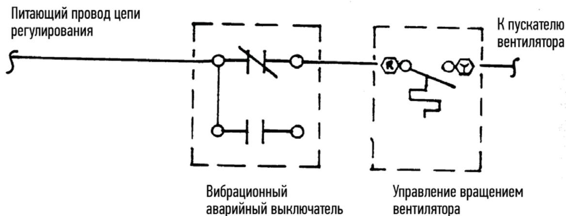
Рисунок 13.5Б Установка вибрационного аварийного выключателя
