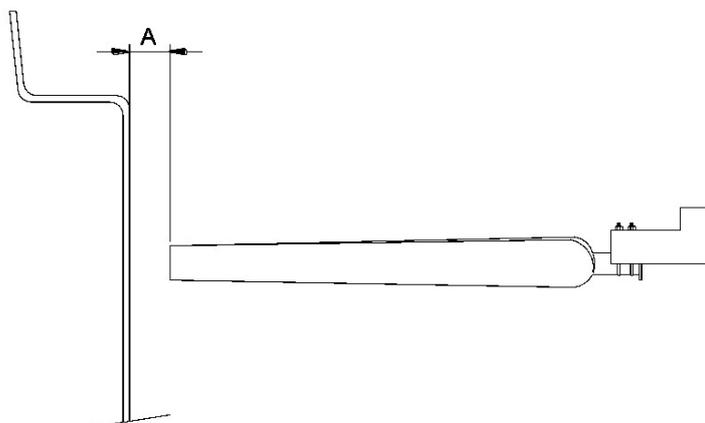
**Таблица 7.6 Минимальный допустимый зазор между лопастями вентилятора и корпусом градирни**
