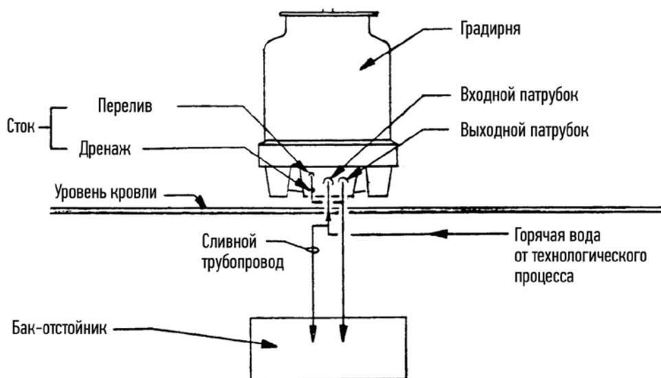
В случае, если установка удаленного бака-отстойника невозможна по причине неподходящего для этого расположения градирни или нехватки места, вода в резервуаре должна подогреваться погружными электрическими нагревателями (см. раздел 3.11).
