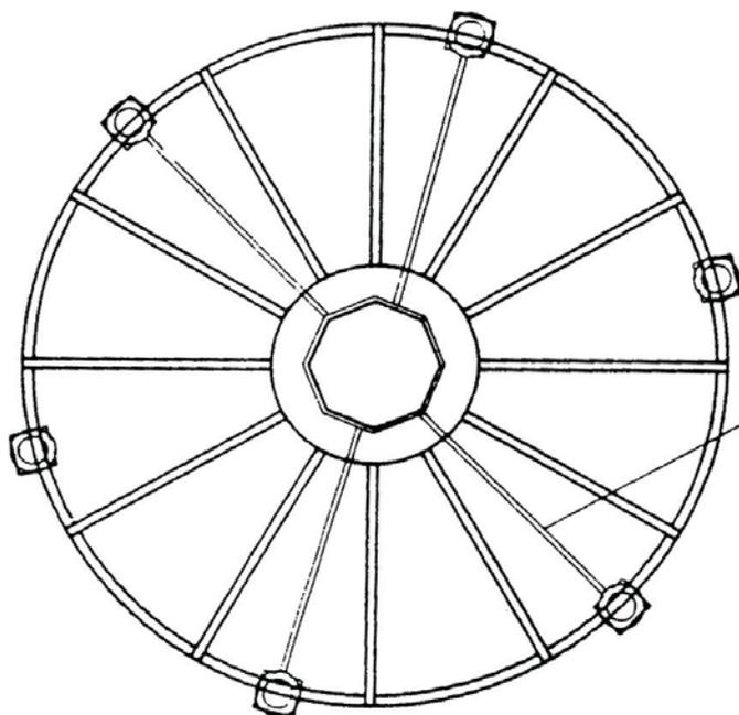
Для поддержки поддона во время транспортирования его перевязывают тросом с опорами (количество точек подъёма варьируется в зависимости от размера градирни-см.таблицы)
